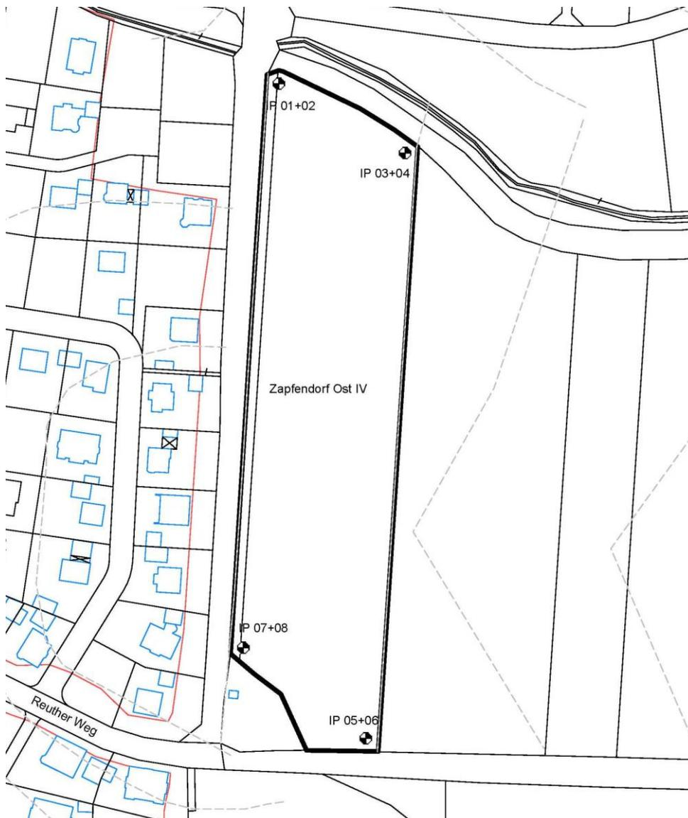
Übersichtslageplan im Schallschutzprogramm - 4 Immissionspunkt-Standorte mit insgesamt 8 Immissionspunkten
