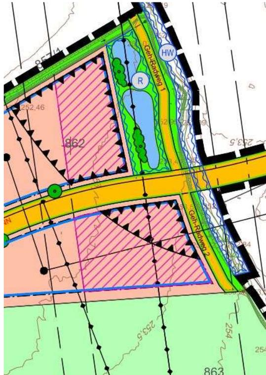
Abb. 2: 110-kV-Freileitung mit Schutzzone
